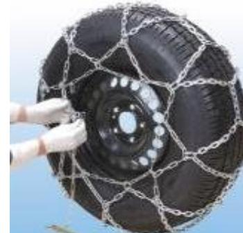
4.Napínanie páku prevlečieme niektorým článkom napínacej reťaze a po sklopení páky zhodnotíme napínaci účinok. Ak je napnutie nedostatočné, musíme páku znova uvoľniť a navliecť do vzdialenejšieho článku. Zároveň skontrolujeme polohy prevlečených článkov. Tento postup opakujeme pokým nedosiahneme želaný napínací účinok.
