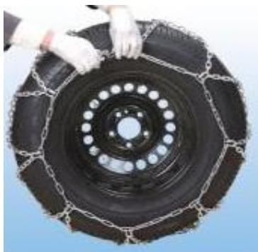
2. Spojovacím háčikom spojíme vnútornú pozdižnu reťaz. Týmto krokom je ukončená manipulácia na vnútorej strane pneumatiky.
