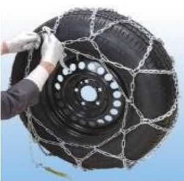
3. Na vonkajšej strane pneumatiky obdobne spojíme spojovacím háčikom vonkajšiu pozdižnu reťaz. Pristúpime potom k samotnému došponovaniu reťaze. Napínaciu reťaz prevlečieme cez kruhové oká, ktoré sú umiestnené na vonkajšej pozdižnej reťazi.
