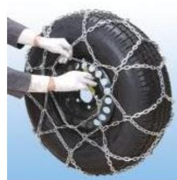
5.V napnutej polohe napínacie páku zaistíme pomocou poistného článku. Zvyšnú časť napínacej reťaze prevlečieme okolo vonkajšej pozdižnej reťaze späť a pomocou pérového háku zahákneme opäť do vonkajšej pozdižnej reťaze. Týmto je základná montáž ukončená.
