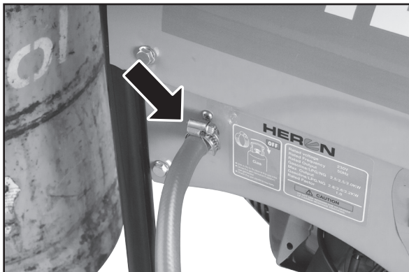
A gáztömlő csatlakoztatási módja 14. ábra
